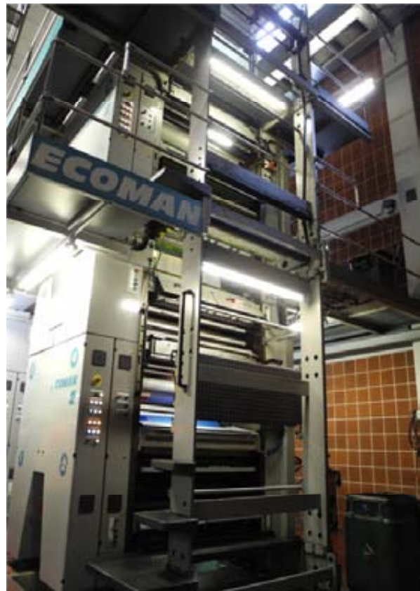
Druckmaschine MAN ECOMAT, Gewicht 200t, Höhe 12m Transportgeschwindigkeit des Papiers 8m/s
